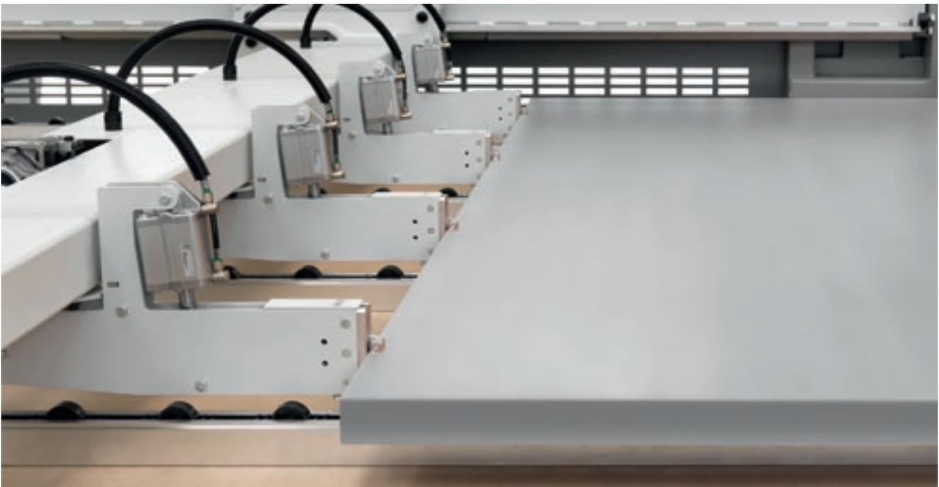
Präzise und schnelle Positionierung der Platten für höchste Schnittgenauigkeit dank des stabilen Schiebers, der durch einen Brushless-Motor angetrieben wird. Die Gleitfläche unterhalb des Schiebers ist mit unabhängigen freilaufenden Rollen ausgestattet, um Abdrücke auf Platten mit empfindlichen Oberflächen zu vermeiden.
